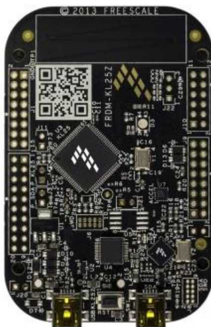
Figura 5. Platforma de dezvoltare cu Freescale Kinetis KL25Z
