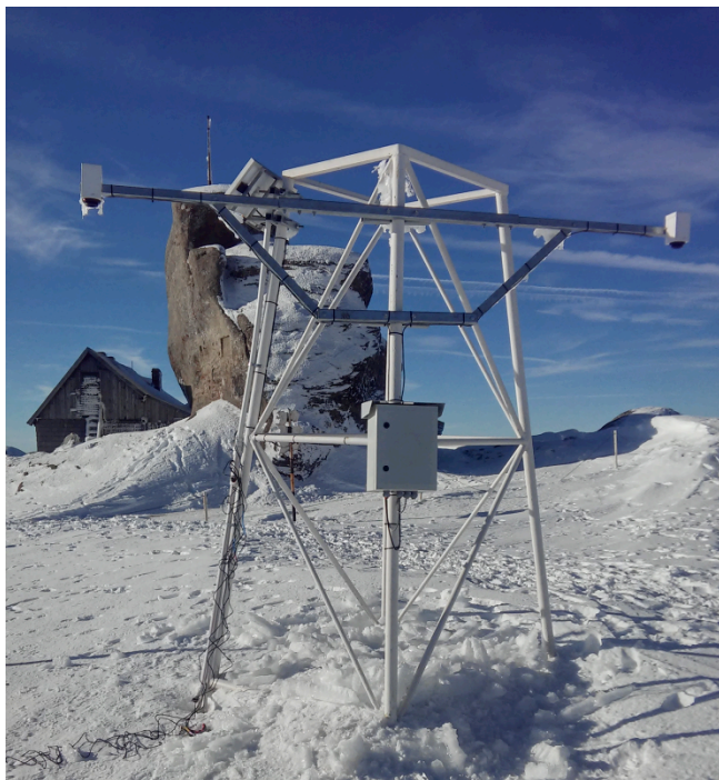
Figura 1: Sistem de măsură cu doi traductori ultrasonici de înălțime strat zăpadă, doi traductori de temperatură-umiditate și 5 traductori de temperatură strat zăpadă. Locația: Stația Meteorologică Vârful Omu
